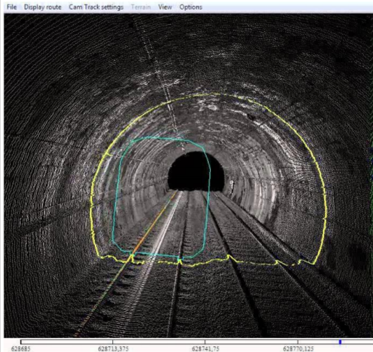
Diseño 3D por inestabilidad de túnel
